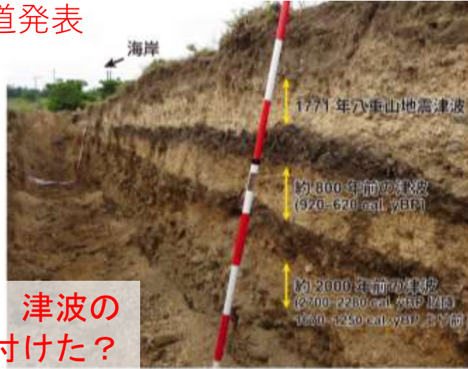
図 3-42 石垣島における砂質津波堆積物のトレンチ調査の様子 (北村晃寿氏提供) 年代はAndo et al.(2008)に基づく
